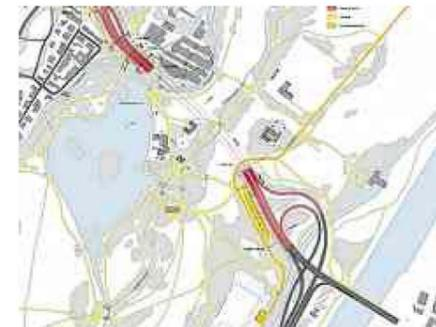
Der Tunnel auf dem Plan: Die rot eingezeichneten Flchen sind die bis zu sechs Meter tiefen Trge in und aus dem Tunnel.
